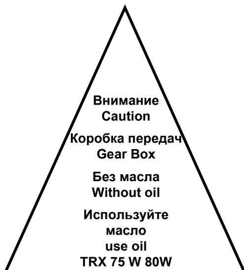
Этикетка для коробок передач с синхронизатором MONO-CONE
